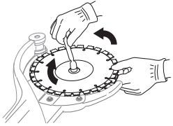
**AVISO** Es muy importante que los discos de corte giren cuando se aprieta la tuerca. Así se asegura que la correa no es apretada entre las mitades de polea integradas en los discos de corte cuando los discos/poleas se unen con la tuerca. Se recomienda hacer esta operación de forma intermitente; es decir, apretar un poco, girar un poco y repetir hasta que los discos están fijos.
