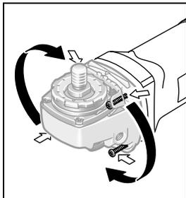
Es posible girar el cabezal del engranaje en pasos de 90°. Ello le permite colocar el interruptor de conexión/desconexión en una posición de operación más cómoda, p. ej., si fuese Ud. zurdo.
