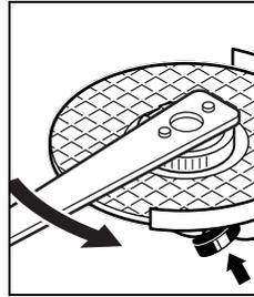
Una tuerca de fijación rápida, correctamente montada, puede aflojarse a mano girando el anillo moletado en sentido contrario a las agujas del reloj.
