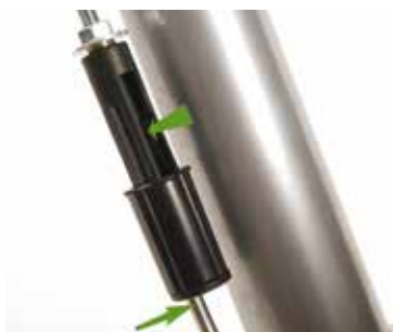
Coloque el tubo de succión (A) y el vástago de control del tambor (B).
