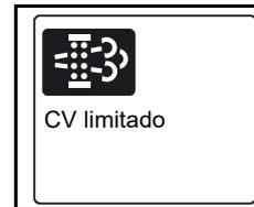
Se produce la regeneración del filtro de partículas. La potencia del motor queda limitada al 50 %.
