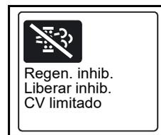
El testigo en el interruptor se apaga. Se produce la regeneración del filtro de partículas. La potencia del motor queda limitada al 50 %.
