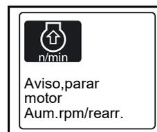
Se produce la regeneración del filtro de partículas. La potencia del motor queda limitada al 50 %.
