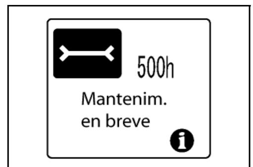
Si se alcanza o supera el tiempo de un intervalo de mantenimiento, en el visualizador aparece el mensaje "Mantenimiento pendiente".
