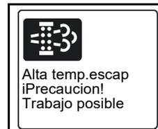
La temperatura de los gases de escape aumenta durante la regeneración del filtro de partículas. La excavadora puede seguir operándose.
