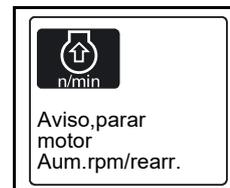
El motor se apaga automáticamente. Es necesario volver a arrancar el motor y aplicar un régimen superior a 1650 r.p.m.
