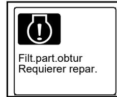
El visualizador muestra un mensaje como el de la imagen de la derecha. Además, el testigo de aviso parpadeará en color rojo y sonará una señal acústica a intervalos.
