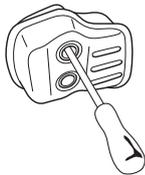
Si el silenciador de su máquina lleva rejilla apagachispas, límpiela a intervalos regulares. La obturación de la rejilla produce el sobrecalentamiento del motor, con el riesgo consiguiente de averías graves.
