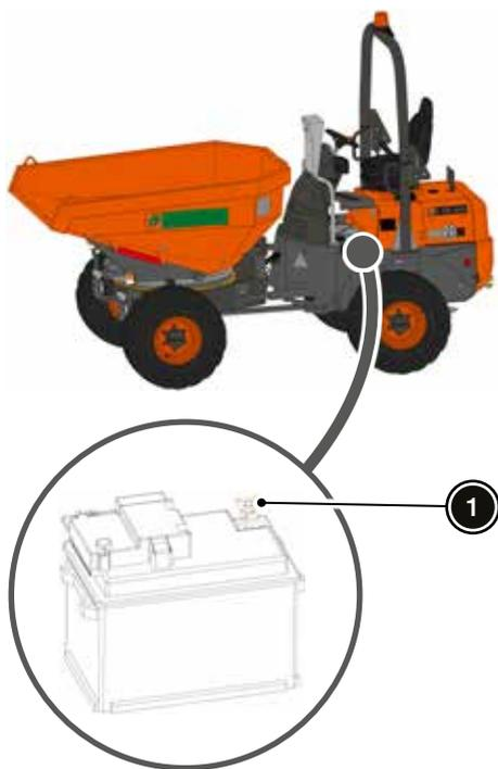
Abrir la tapa de mantenimiento izquierda y girar el desconector de la batería. **ACCESORIO**
