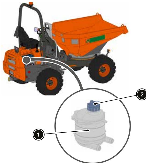
3. Llenar el depósito con líquido refrigerante hasta que el nivel esté entre el máximo y el mínimo.
