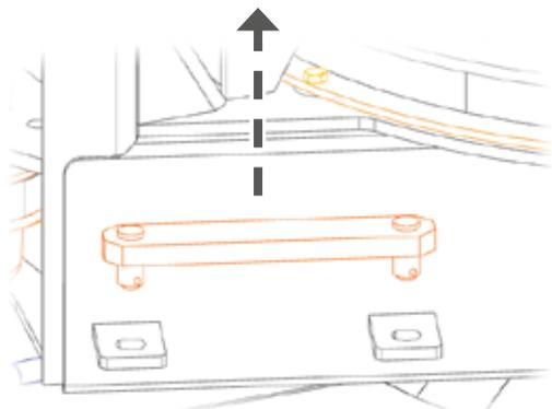
3. Colocar la barra inmovilizadora (1) de forma que una ambos cuerpos del chasis (2) y colocar los seguros (3).
