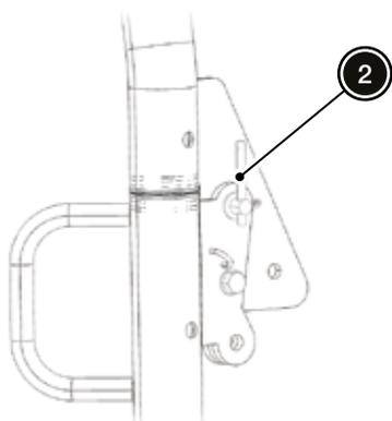
3. Con cuidado abatir la parte superior de la estructura de protección contra vuelco (ROPS) hasta su posición de transporte.
