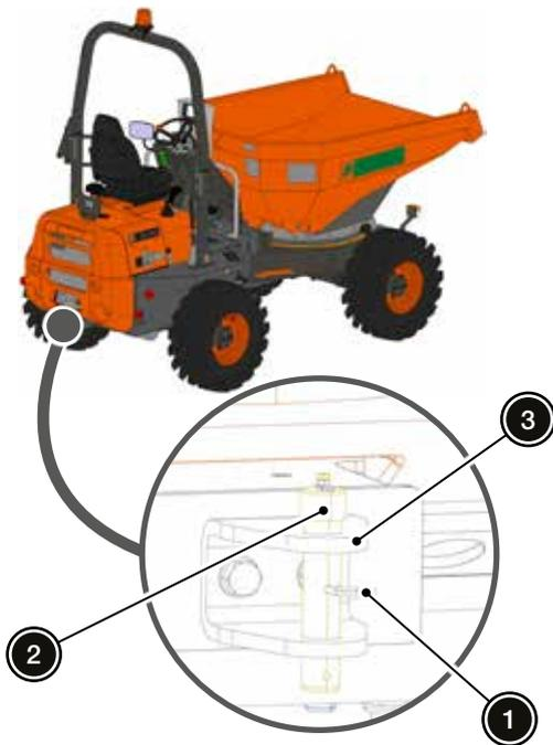
2. Colocar el pasador a través del soporte fijado al contrapeso y el dispositivo de remolcado. Bloquear el pasador con el seguro.
