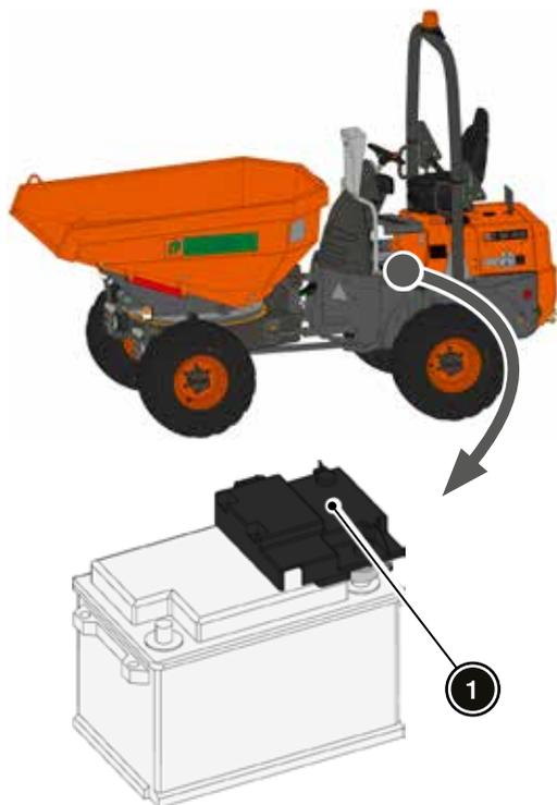
2. Desmontar la tapa (1) del borne positivo.
