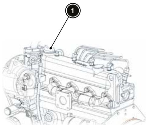
3. Llenar con aceite hasta que el nivel esté entre el máximo y el mínimo de la varilla de medición (1).
