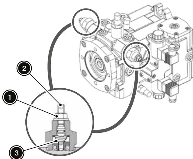
3. Con una llave de 13 mm, aflojar las tuercas (1) de cada una de las dos válvulas, girándolas dos vueltas en sentido antihorario.
