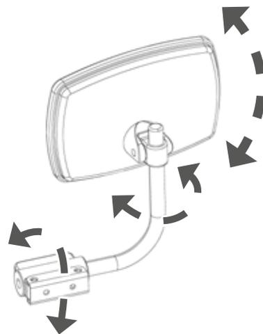
*Ajuste de la posición de los espejos retrovisores*
