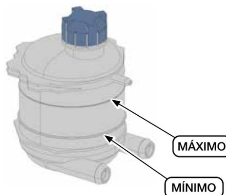
4. Colocar el tapón del depósito de líquido refrigerante y cerrar la tapa de mantenimiento derecha.
