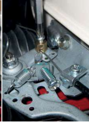
3 FIJAR LA SIRGA DEL ACELERADOR
