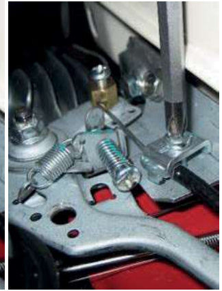
4 FIJAR LA FUNDA DEL ACELERADOR
