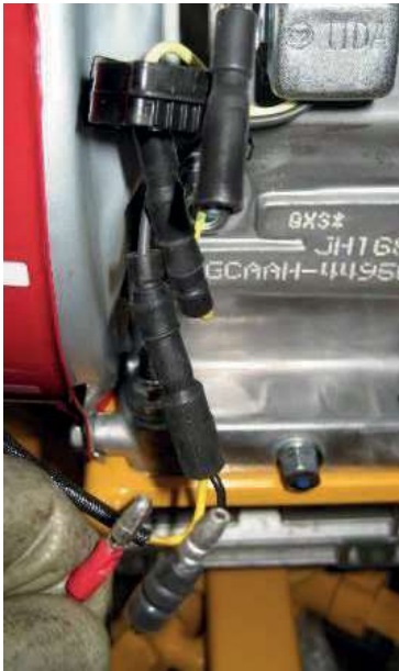
1 DESCONECTAR EL CABLE NEGRO DE LA BUJÍA
