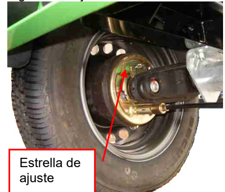
Fig. 6.15.1 Ajuste del freno
