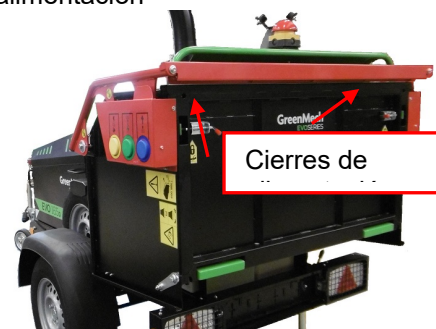
Fig. 4.2 Cierres del canal de alimentación
