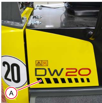
Fig. 272: Rejilla de ventilación
