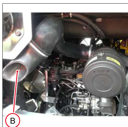
Fig. 275: Aspiración de aire
