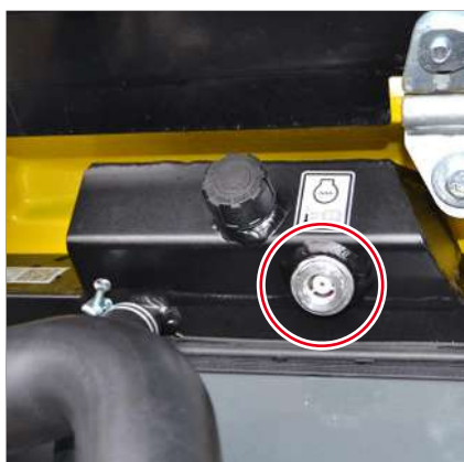
Fig. 247: Control del nivel de agente refrigerante
