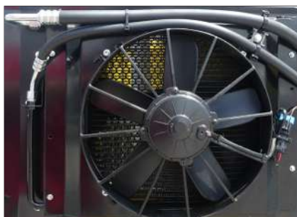
Fig. 286: Condensador de climatización
