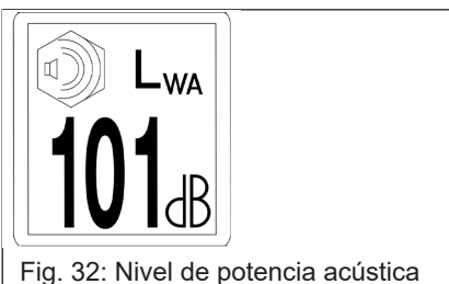
Fig. 32: Nivel de potencia acústica
