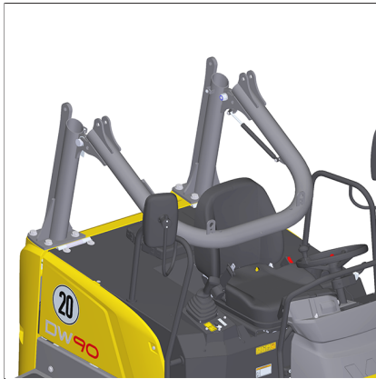
Fig. 87: Barra antivuelco plegada hacia abajo
